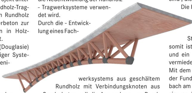
werksystems aus geschältem Rundholz mit Verbindungsknoten aus Sonderbeton soll die Anwendung von Rundholz neue Möglichkeiten finden.
